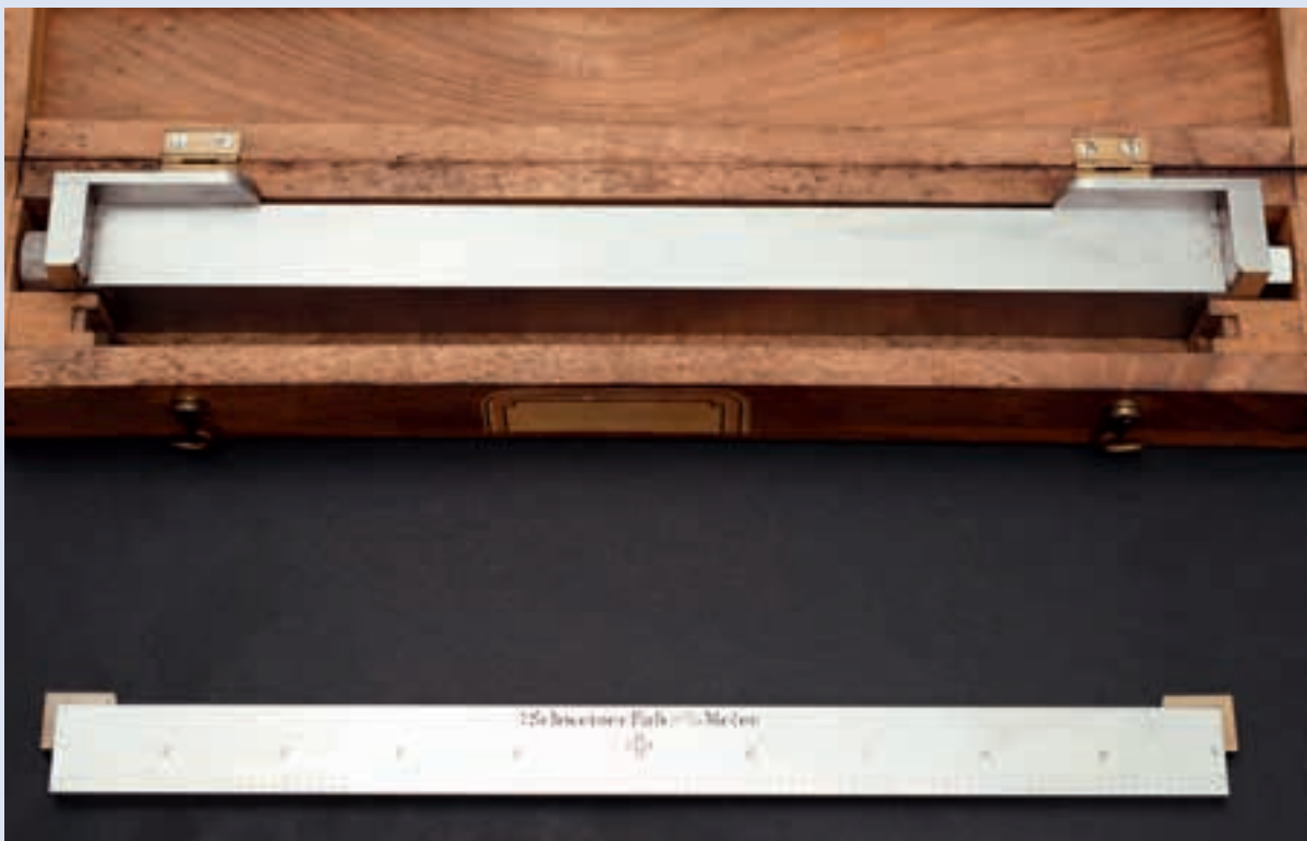
Urmass des Schweizer Fusses aus dem Jahre 1854. Der Eisenmassstab mit Matrize wurde von Hr. Oeri, Mechaniker in Zürich, hergestellt. Dieses Urmass diente bis 1875 als Referenzmass.
